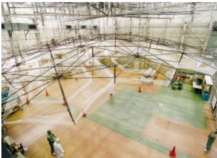
E T S - VIII 搭載用大型アンテナの展開試験風景
