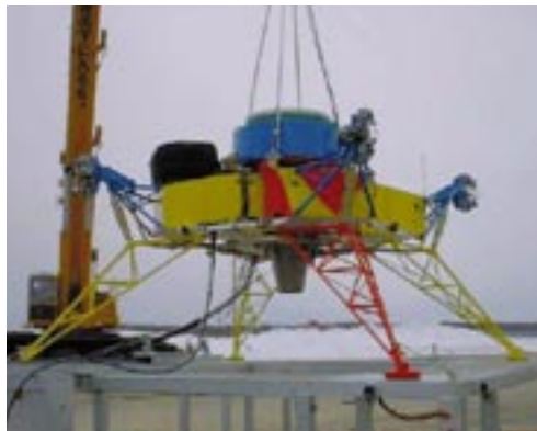
写真1 FTB外観(テザー試験準備中)
